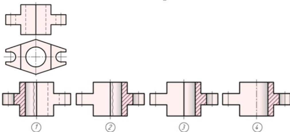
11. По заданным видам определить название каждого вида согласно проекционной связи
